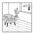
Upewnij się, że temperatura wewnątrz pomieszczenia zawsze przekracza 5°C. Zalecana temperatura wnętrza powinna utrzymywać się w zakresie 18–30°C. Ważne jest, aby temperaturę podłoża również utrzymywać we wspomnianych granicach.
