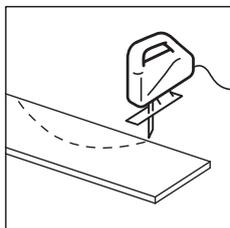
Для будь-якого іншого розрізу використовуйте пилку. Залежно від типу пилки панель слід розташовувати стороною з малюнком вгору або вниз. Перед різанням протестуйте його на непотрібному елементі, щоб визначити, як краще розрізати панель (стороною з малюнком догори чи донизу).
