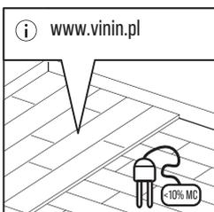
Панелі VIN IN підходять для монтажу на дерев'яну підлогу, якщо немає видимих слідів цвілі, бруду або комах. Вологість деревини не повинна перевищувати 10%, тому що нове покриття може утримувати вологу, через що деревина з часом починає гнити. Крім того, слід перевірити, чи підлога є рівною, і закріпити будь-які незакріплені елементи цвяхами або шурупами.
