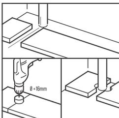
У рядах, де є труби, забезпечте таке розташування панелей, щоб труба опинилася точно посередині між панелями. Виберіть свердло розміром, що відповідає діаметру труби плюс 16 мм. З'єднайте панелі разом на короткій стороні, а потім просвердліть отвір у центрі, де дві панелі з'єднуються. Тепер панелі готові до монтажу.
