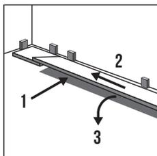
Щоб прикріпити наступну дошку, вставте крайній язичок у торцевий паз першої дошки під кутом приблизно 15-20°. Після опускання дошка зафіксується на місці.
