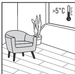
Стежте, щоб температура в приміщенні завжди була вище 5°C. Рекомендована температура в приміщенні повинна бути в межах 18-30°C. Важливо підтримувати температуру основи в зазначених межах.
