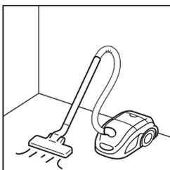
Основа повинна бути чистою, сухою та очищеною від будівельного сміття, піску, бруду та інших предметів. Випираючі нерівності необхідно усунути. Перед укладанням основу слід ретельно підмести та пропилососити для видалення всіх домішок.
