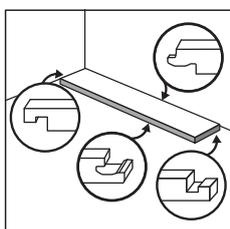
Монтаж панелей починайте з кутка кімнати, розташувавши першу дошку язичком до стіни. Використовуйте прокладки вздовж кожної стіни, щоб між стіною та підлогою залишалося 8 мм розширення.
