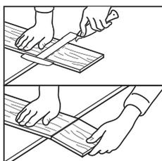
Якщо є необхідність вкоротити панель за допомогою прямого поперечного розрізу, розріжте її спрямовуючи лицьовою стороною вгору, використовуючи спеціальний ніж для вінілових панелей. Щоб розрізати вінілову дошку, намалюйте пряму лінію, уздовж якої потрібно розрізати. За допомогою ножа зробіть кілька міцних надрізів на поверхні. Ніколи не потрібно повністю різати вінілову дошку. Потім розламайте панель обома руками.
