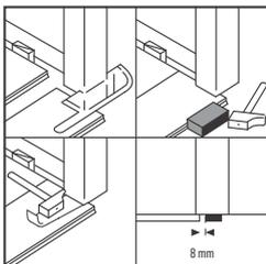
Ми рекомендуємо обрізати профілі дверної коробки біля порогів або дверних отворів. Щоб забезпечити правильний розріз, переверніть панель лицьовою стороною вниз із підкладкою під нею і покладіть її на підлогу біля дверної рами. Це дозволить зробити надріз на потрібній висоті. Потім покладіть багатофункціональний інструмент або ручну ножівку на панель і розріжте дверну коробку.
