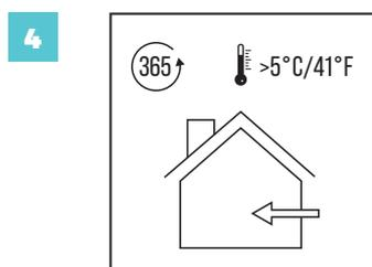
Вінілові підлоги VIN IN призначені тільки для внутрішнього використання в опалювальних приміщеннях з температурою вище 5°C (41°F). Панелі найкраще працюють при кімнатній температурі (18-30°C). Панелі VIN IN не можна розміщувати на зовнішніх поверхнях, у саунах чи присадибних ділянках, зимових садах, вагончиках, човнах, критих верандах та кімнатах, що піддаються затоплення.
