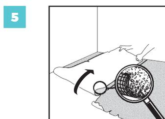
Тип і якість основи та її підготовка мають величезний вплив на кінцевий ефект монтажу. Пам'ятайте, що нерівна поверхня може призвести до деформацій і розривів у продуктах VIN IN. Основа повинна бути стабільна і міцно закріплена. Крім того, плаваючу підлогу не можна встановлювати на м'яку, пошкоджену або пухку основу. Занадто м'які підлогові покриття, наприклад, килими, голкопробивний ковровлін, м'які вінілові та попередні плаваючі підлогові покриття слід усунути.
