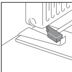
У місцях, де важко встановити панелі за допомогою колодки для обстукування (наприклад, під радіаторами), їх можна з'єднати за допомогою скоби для монтажу та молотка.
