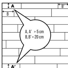
Перед початком монтажу ретельно виміряйте довжину і ширину приміщення, щоб детально спланувати оптимальне розташування панелей. Розміри позначені як A і A' не можуть бути менше ніж 5 см, а B і B' не можуть бути менше ніж 20 см.
