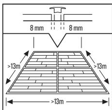
Температура в приміщенні постійно змінюється, тому дуже важливо, щоб підлога мала здатність розширюватися і стискатися. Тому з обох боків підлоги, навколо труб, порогів і під дверними коробками, необхідно залишити розширювальний зазор 8 мм.
