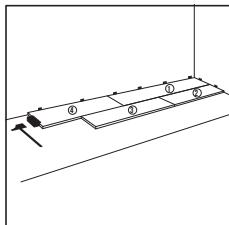
Pokud není možné použít metodu A, např. na těžko přístupných místech, můžete použít metodu B, která spočívá v klepání do panelů. Tím odpadá nutnost jejich zvedání. Tato metoda vyžaduje speciální blok na poklepávání pro systém UNICLIC. Panely by se neměly spojovat jednoduchým poklepkem. Aby nedošlo k poškození panelů, klepejte je k sobě postupně. Nejprve můžete položit krátkou nebo dlouhou stranu panelu pod úhlem a poté klepáním spojit druhou stranu.
