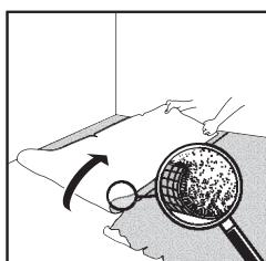
Typ a kvalita podkladu a jeho příprava mají velký vliv na konečný výsledek montáže. Pamatujte, že nerovný podklad může vést k deformaci a vzniku mezer ve výrobcích VIN IN. Podklad by měl být stabilní a bezpečně upevněný. Kromě toho neinstalujte plovoucí podlahy na měkké, poškozené nebo uvolněné podklady. Příliš měkké podlahové krytiny, jako jsou koberce, jehlové koberce, měkký vinyl a předchozí plovoucí podlahové krytiny, je nutné odstranit.
