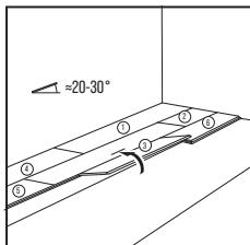
Po montáži každého panelu a před přechodem k dalšímu zkontrolujte spojení všech krátkých a dlouhých stran. Ujistěte se, že nevznikly žádné mezery nebo výškové rozdíly.
