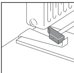
Tam, kde je příliš obtížné instalovat panely pomocí příklepového nástroje (např. pod radiátory), je lze spojit pomocí utahováku a kladiva.
