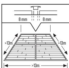
Teplota v místnosti se neustále mění, proto je velmi důležité, aby podlaha měla prostor pro roztahování a smršťování. Proto by měla být na každě straně podlahy, kolem rour, prahů a pod dveřními zárubněmi ponechána dilatační mezera 8 mm. Dilatační mezery lze zakrýt lištami připevněnými ke stěnám nebo dilatačním profilem. Ve většině případů není dilatační profil mezi místnostmi nutný. Měl by však být použit, pokud:
