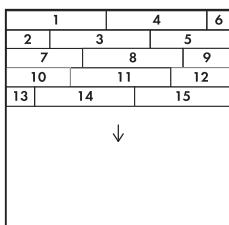
Pokračujte v instalaci dalších řad panelů směrem k okraji místnosti. Nejjednodušší je pracovat vsedě na dříve instalovaných panelech.
