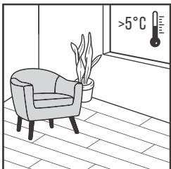
Zajistěte, aby vnitřní teplota byla vždy vyšší než 5°C. Doporučená vnitřní teplota by se měla pohybovat v rozmezí 18-30°C. Je důležité udržovat v uvedených mezích také teplotu podkladu.
