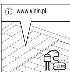
Panely VIN IN jsou vhodné pro instalaci na dřevěné podklady, pokud nejsou viditelné známky plísni, nečistot nebo hmyzu. Vlhkost dřeva nesmí překročit 10 %, protože nový podklad může zadržovat vlhkost, což může po určité době způsobit hniličku dřeva. Kromě toho je třeba zkontrolovat, zda je podklad rovný, a případné uvolněné části upevnit pomocí hřebíků nebo šroubů.
