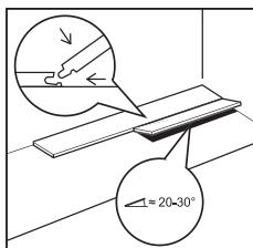
Pro usnadnění montáže spojte první tři řady od stěny tak, abyste si mohli při práci na panely sednout. Poté přesuňte první tři řady na cílové místo ke stěně s nasazenými rozpěrnými klíny. Doporučujeme provádět dodatečné kontroly rovinnosti, abyste se ujistili o rovinnosti během instalace. Nezapomeňte použít dilatační klíny pro 8 mm široké dilatační spáry po obvodu.
