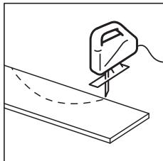
Pro jakékoli jiné řezání použijte pilu. V závislosti na typu pily by měl být panel položen stranou se vzorem nahoru nebo dolů. Před řezáním proveďte zkoušku na nadbytečném kusu, abyste zjistili, jak řezat panel co nejpřesněji (stranou se vzorem nahoru nebo dolů).
