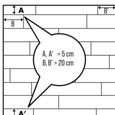
Před instalací je třeba pečlivě změřit délku a šířku místnosti, aby bylo možné podrobně naplánovat optimální rozmístění panelů. Rozměry označené A a A' nesmí být menší než 5 cm a B a B' nesmí být menší než 30 cm.
