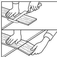
Pokud potřebujete panel zkrátit rovným řezem, nařežte desku stranou se vzorem nahoru pomocí speciální řezačky vinylových panelů. Chcete-li vinylový panel rozříznout, nakreslete rovnou čáru, podél které bude řez proveden. Pomocí nože provedte bezpečný řez do plochy. Není nutné vinylový panel zcela proříznout. Poté panel oběma rukama zlomte.
