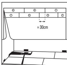
Tam, kde je instalace panelů s nacvakávacím systémem UNICLIC pomocí příklepového bloku příliš obtížná, např. u zdi, můžete panely spojit pomocí utahováku a kladiva.
