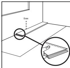
Instalaci začněte prvním panelem, který se instaluje v rohu místnosti. Pomocí pily odřízněte zaklapávací profily podél dlouhých a krátkých hran panelů. U dalších panelů, které se mají instalovat v první řadě, odstraňte po instalaci prvního panelu v rohu také zaklapávací profily z hran, které mají být položeny ke stěně. Odříznutí zaklapávacích profilů je nutné u panelů instalovaných přímo ke stěně, aby byla zajištěna dostatečná dilatační mezera. Je třeba ponechat dilatační mezeru 8 mm.
