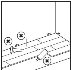
Výrobek instalovaný v systému plovoucí podlahy nesmí být trvale připevněn k podkladu, podložce, nábytku nebo jiným elementům.
